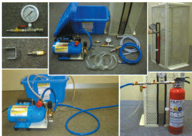
小型消火器水圧試験機 (3MPa 迄の測定が可能)
